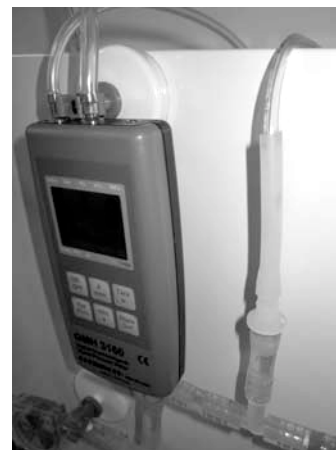
Abb. 9: Das Monometer kann mit dem mitgelieferten Magnethalter an der Metalltafel befestigt werden. Dieser wird dazu zwischen die Anschlussoliven des Messgeräts gedrückt.
