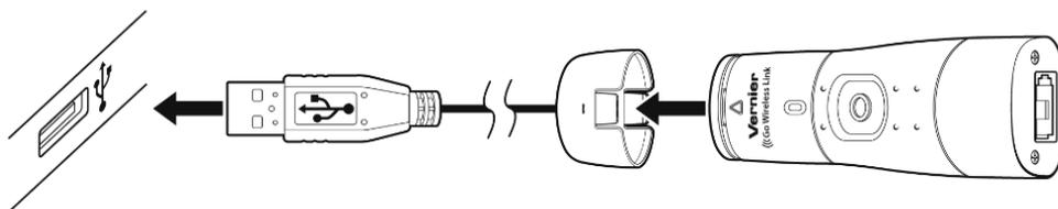
Sie können ebenfalls mit einer Go Wireless Ladestation (Bestell-Nr. GW-CRG) bis zu acht Go Wireless Link (oder andere Go Wireless Geräte) gleichzeitig laden. Der Ladestatus wird mit der blauen LED angezeigt. Solange sie leuchtet, wird geladen; der Ladevorgang ist beendet wenn sie erlischt.
