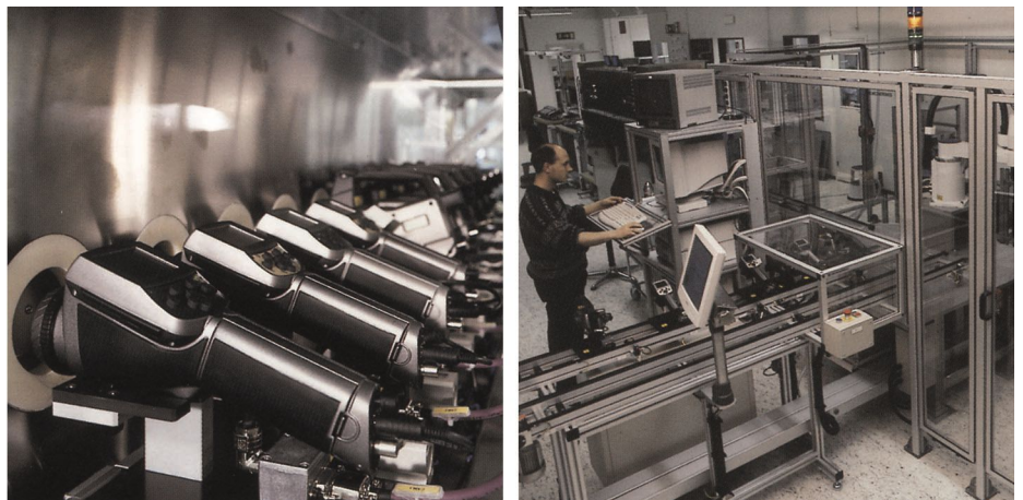
Abbildung 12.5 LINKS: Testen von Infrarotkameras in der Klimakammer; RECHTS: Roboter zum Testen und Kalibrieren von Kameras
