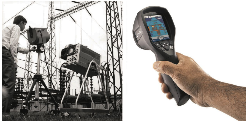
Abbildung 12.2 LINKS: Modell 661 der Thermovision aus dem Jahr 1969. Die Kamera wog ca. 25 kg, das Oszilloskop 20 kg und das Stativ 15 kg. Für den Betrieb wurden darüber hinaus ein 220-Volt-Generator und ein 10-Liter-Gefäß mit flüssigem Stickstoff benötigt. Links neben dem Oszilloskop ist der Polaroid-Aufsatz (6 kg) zu erkennen. RECHTS: Die FLIR i7 aus dem Jahr 2012. Gewicht: 0,34 kg einschließlich Akku.
