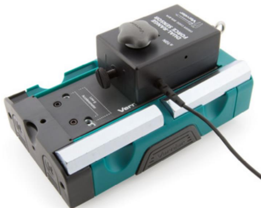
Figur 10: Experimentierwagen mit zwei Massentücken und «Dual-Range-Force-Sensor»
