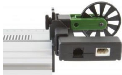
Figur 44: Ultra Pulley Attachment SPA mit Pulley Bracket B-SPA und Lichtschranke
