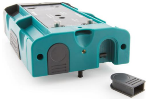
Figur 9: Experimentierwagen mit Stos-Einschüben, links: montiert, rechts: entfernt
