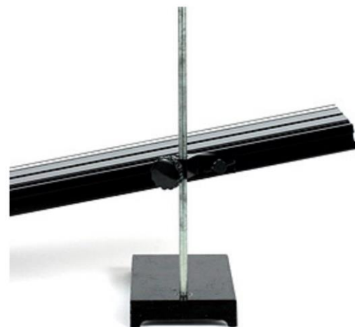
Figur 24: Fahrbahn als schiefe Ebene mit Stangen-Muffe Stativstange und Stativfuss
