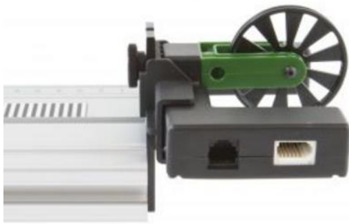
Figur 19: stirnseitige Befestigung einer Lichtschranke mit Speichenrad (Ultra Pulley)
